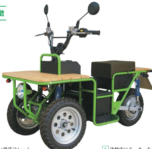
3 前輪を二輪・後輪を一輪の構成とした三輪車で、雪道でも乗れる安定感
